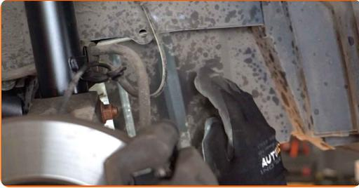
**17** Schrauben Sie die Befestigungen der seitlichen Kunststoffabdeckung des Motors ein. Verwenden Sie Stecknuss Nr. 10. Verwenden Sie einen Kreuzschlitzschraubendreher.
