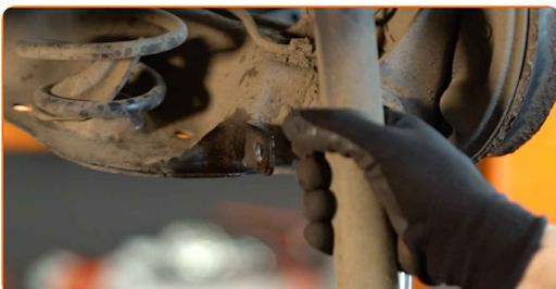
16 Die Staubkappe des Stoßdämpfers und den Anschlagpuffer entfernen.
