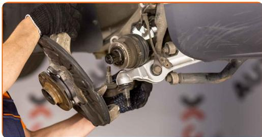
**31** Verbinden Sie den Unterarm mit dem Achsschenkel.
