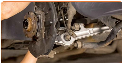
**32** Schrauben Sie die Radnaben Achsmutter an.
