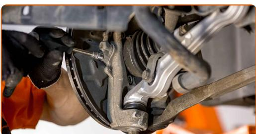
**48** Die Antriebswellenmutter festziehen. Verwenden Sie Inbusschlüssel Nr. H17. Verwenden Sie einen Drehmomentschlüssel. Ziehen Sie ihn mit 115 Nm Drehmoment fest.+180°
