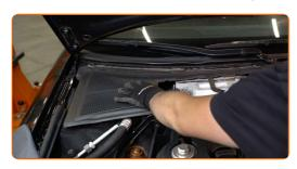
Bauen Sie die Dichtung der Windabweiserabdeckung ein.
