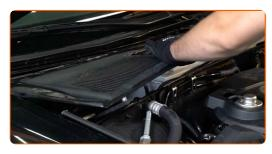
Lösen Sie die Befestigungsclips der Innenraumfilterabdeckung. Entfernen Sie den Gehäusedeckel des Innenraumfilters.
