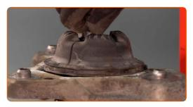
Ziehen Sie die Federbeinkolbenstangenmutter an. Verwenden Sie Inbusschlüssel Nr. H6. Verwenden Sie Stecknuss Nr. 16. Verwenden Sie einen Drehmomentschlüssel. Ziehen Sie ihn mit 50 Nm Drehmoment fest.
