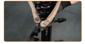
Installieren Sie das Federbein am Radlauf.
