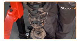
Installieren Sie die Feder am Stoßdämpfer.
