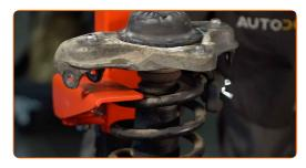
Entfernen Sie die Stangenmutter des Federkolben. Verwenden Sie Inbusschlüssel Nr. H6. Verwenden Sie Stecknuss Nr. 16. Verwenden Sie einen Ratschenschlüssel.
