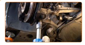
Behandeln Sie alle Gelenke des Querlenkers. Verwenden Sie Mehrzweckfett. Verwenden Sie einen flachen Schraubendreher.
