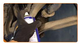
Drehen Sie die Befestigungen heraus, die die Druckstange mit dem Stabilisator verbinden. Verwenden Sie Ring-Gabelschlüssel Nr. 16. Verwenden Sie Stecknuss Nr. 16. Verwenden Sie einen Ratschenschlüssel.
