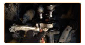
Lösen Sie den unteren Bereich des Federbeins. Benutzen Sie ein Brecheisen.
