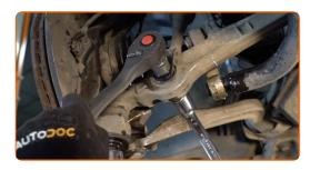
Entfernen Sie die Befestigungsschraube.
