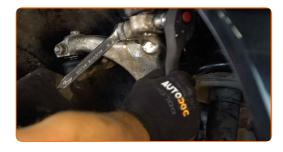
Entfernen Sie die Befestigungsschraube.
