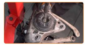
Entfernen Sie das zusammengebaute Federbein.
