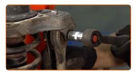
Entfernen Sie die Befestigungsschraube.
