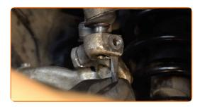
Trennen Sie den oberen Querlenker vom Achsschenkel (2 Stück). Verwenden Sie einen Splintentreiber. Benutzen Sie einen Hammer.
