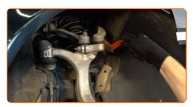
Schrauben Sie die oberen Steuerarmverschlüsse ab (2 Stück). Verwenden Sie Ring-Gabelschlüssel Nr. 18 (2 Teile). Verwenden Sie Stecknuss Nr. 18. Verwenden Sie einen Ratschenschlüssel.
