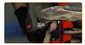
Lösen Sie die Befestigungen, die die Querlenker mit der Federbeinaufnahme verbinden. Verwenden Sie Ring-Gabelschlüssel Nr. 16. Verwenden Sie Stecknuss Nr. 16. Verwenden Sie einen Ratschenschlüssel.
