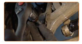
Entfernen Sie den Träger unter dem Arm.
