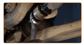
Entfernen Sie die Stabilisatorstange. Benutzen Sie ein Brecheisen.
