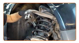
Stellen Sie das Dämpferbein auf das Federspannwerkzeug.
