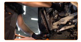
Lösen Sie die obere Befestigung des Domlagers. Verwenden Sie Stecknuss Nr. 16. Verwenden Sie einen Ratschenschlüssel.
