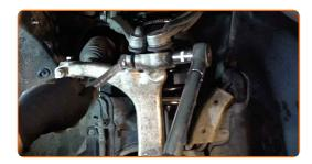
Ziehen Sie das Befestigungselement an, das die Druckstange mit dem Stabilisator verbindet. Verwenden Sie Ring-Gabelschlüssel Nr. 16. Verwenden Sie Stecknuss Nr. 16. Verwenden Sie einen Drehmomentschlüssel. Ziehen Sie ihn mit 40 Nm Drehmoment fest.+90°
