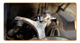
Montieren Sie den Querlenker.
