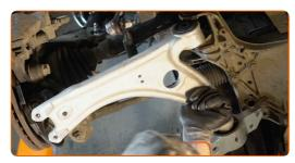
Schrauben Sie die vordere Armbefestigung an. Verwenden Sie Stecknuss Nr. 18. Verwenden Sie einen Ratschenschlüssel.
