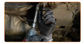
Entfernen Sie die vordere Befestigung des Querlenkers.
