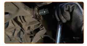
Schrauben Sie das hintere Befestigungselement heraus, das den Querlenker mit der Karosserie verbindet. Verwenden Sie Stecknuss Nr. 18. Verwenden Sie ein Windeisen.
