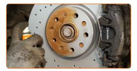
Die Bremsscheibenoberfläche reinigen. Benutzen Sie einen Bremsenreiniger.
