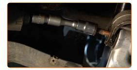
Installieren Sie das hintere Befestigungselement des Querlenkers (2 Stück).
