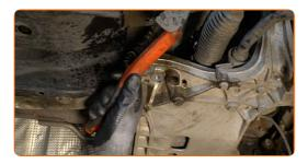
Installieren Sie den Arm. Benutzen Sie ein Brecheisen.
