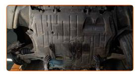
Ziehen Sie die Befestigungen der unteren Ölwannen-Abdeckung fest. Verwenden Sie Stecknuss Nr. 13. Verwenden Sie den Torx T25. Verwenden Sie einen Ratschenschlüssel.
