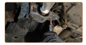
Ziehen Sie die Befestigungen des Kugelgelenks an. Verwenden Sie Stecknuss Nr. 16. Verwenden Sie einen Drehmomentschlüssel. Ziehen Sie ihn mit 60 Nm Drehmoment fest.
