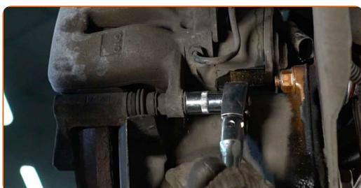
**11** Entfernen Sie den Bremssattel.
