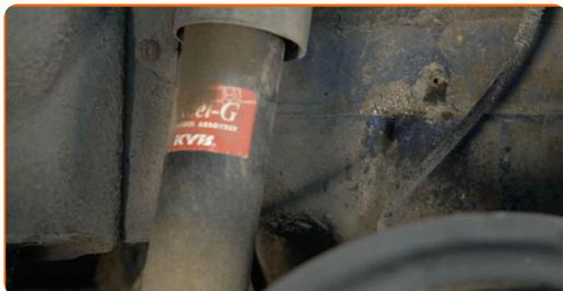
**20** Reinigen Sie die Stoßdämpferbefestigungen. Benutzen Sie eine Drahtbürste. Benutzen Sie WD-40-Spray.
