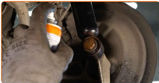
**46** Reinigen Sie die Aufnahmen der Spiralfedern. Benutzen Sie eine Drahtbürste. Benutzen Sie WD-40-Spray.
