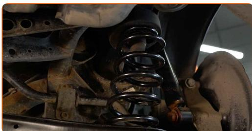
**48** Stützen Sie den Arm. Benutzen Sie einen hydraulischen Getriebeheber. Benutzen Sie ein Brecheisen.
