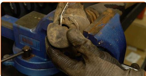
**25** Reinigen Sie die Befestigungen vom Stoßdämpferschaft. Benutzen Sie eine Drahtbürste. Benutzen Sie WD-40-Spray.
