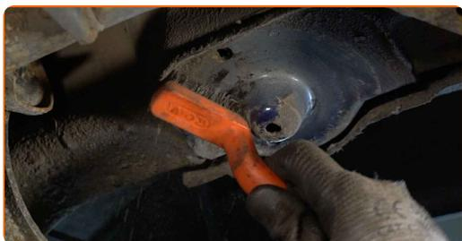
**47** Bauen Sie die Spiralfeder zusammen mit den Gummilager in deren Aufnahmen ein.
