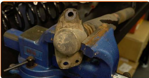
**24** Entfernen Sie die Schutzkappe der Stoßdämpferhalterung. Benutzen Sie ein Brecheisen.
