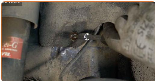
**19** Entfernen Sie die Radkastenabdeckung.
