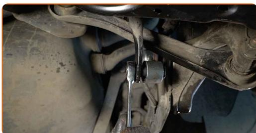
**13** Ziehen Sie das Befestigungselement an, das den Stabilisator mit dem Querlenker verbindet. Verwenden Sie Stecknuss Nr. 16. Verwenden Sie einen Drehmomentschlüssel. Ziehen Sie ihn mit 45 Nm Drehmoment fest.
