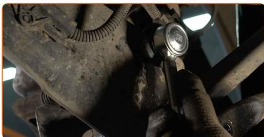
**12** Ziehen Sie die Befestigungselemente des Stabilenkers fest. Verwenden Sie Ring-Gabelschlüssel Nr. 16. Benutzen Sie den XZN #6. Verwenden Sie Inbusschlüssel Nr. H5.
