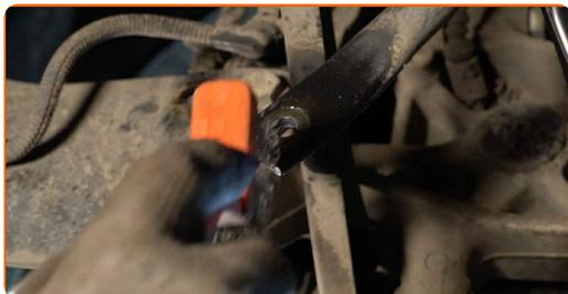
**11** Montieren Sie den Querlenker. Benutzen Sie ein Brecheisen.
