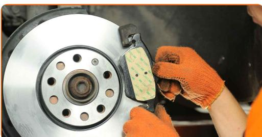
**Austausch: Bremsbeläge – Audi A4 B7 Avant. Tipp:**
