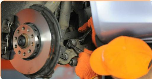
**15** Schrauben Sie das Befestigungselement heraus, das die Druckstange mit dem Stabilisator verbindet. Verwenden Sie Ring-Gabelschlüssel Nr. 16.
