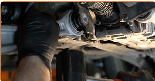
**30** Bringen Sie die Befestigungsschraube an. Benutzen Sie einen Hammer. Verwenden Sie einen Splintentreiber.
