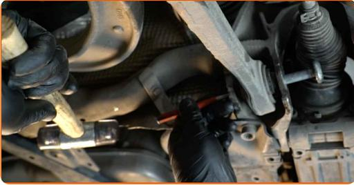
**21** Lösen Sie den Querlenker. Benutzen Sie ein Brecheisen.
