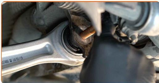
**31** Schrauben Sie das Befestigungselement ein, das den Querlenker mit dem Hilfsrahmen verbindet. Verwenden Sie Ring-Gabelschlüssel Nr. 18 (2 Teile).
