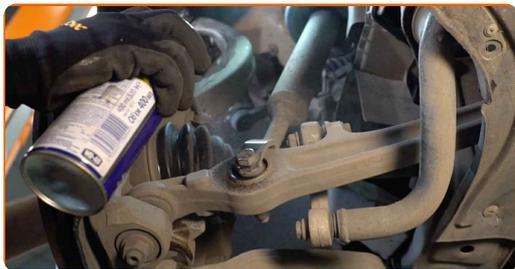
**10** Untere Befestigung der Stoßdämpferfedern abschrauben. Verwenden Sie Ring-Gabelschlüssel Nr. 18. Verwenden Sie Stecknuss Nr. 18. Verwenden Sie einen Ratschenschlüssel.
