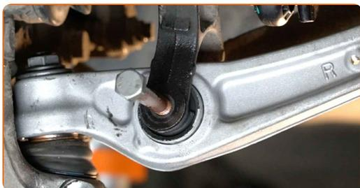
**34** Ziehen Sie das Kugelgelenk an. Verwenden Sie Stecknuss Nr. 18. Verwenden Sie einen Drehmomentschlüssel. Ziehen Sie ihn mit 110 Nm Drehmoment fest.
