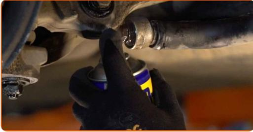
**14** Schrauben Sie das Befestigungselement heraus, das den Stabilisator mit dem Querlenker verbindet. Verwenden Sie Ring-Gabelschlüssel Nr. 13. Verwenden Sie Ring-Gabelschlüssel Nr. 16.
