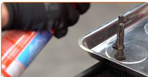
**27** Behandeln Sie die Bremssattel-Führungstifte. Verwenden Sie das Bremssattelführungsbolzen-Fett.
