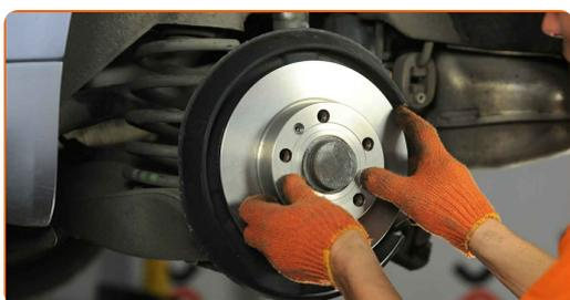
**22** Ziehen Sie die Befestigung der Bremsscheibe fest. Verwenden Sie den Torx T30. Verwenden Sie einen Drehmomentschlüssel. Ziehen Sie ihn mit 5 Nm Drehmoment fest.
