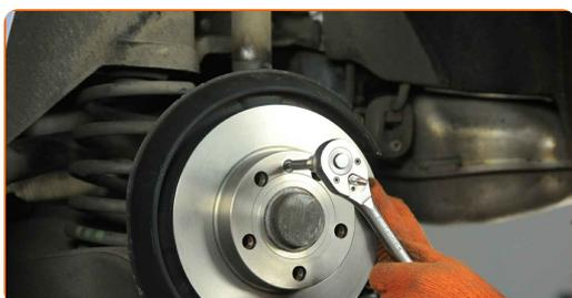
**23** Behandeln Sie die Befestigungsschrauben. Verwenden Sie ein Dichtmittel.
