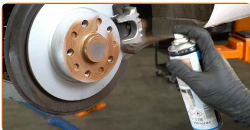
**40** Reinigen Sie die Oberfläche an welcher die Felge montiert werden soll. Benutzen Sie einen Bremsenreiniger.
