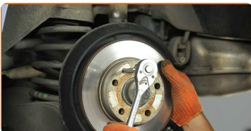
**19** Entfernen Sie die Bremsscheibe.
