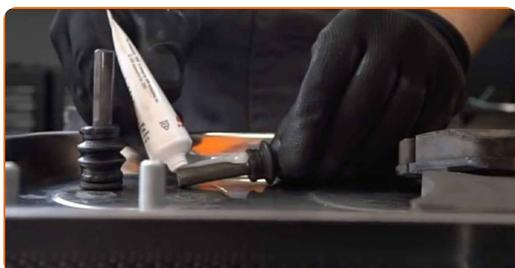
**28** Schrauben Sie die Führungsbolzen hinein.
