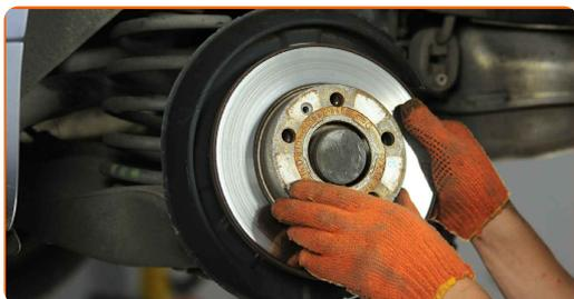
**20** Reinigen Sie die Nabe. Benutzen Sie eine Drahtbürste. Behandeln Sie die Kontaktfläche. Benutzen Sie ein Kupferschmiermittel.
