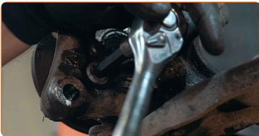
**37** Entfernen Sie die Nabe und das Lager zusammen, da sie eine versiegelte Einheit sind.
