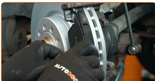
**63** Installieren Sie den Bremssattel und fixieren Sie diesen. Verwenden Sie Inbusschlüssel Nr. H7. Verwenden Sie einen Drehmomentschlüssel. Ziehen Sie ihn mit 30 Nm Drehmoment fest.
