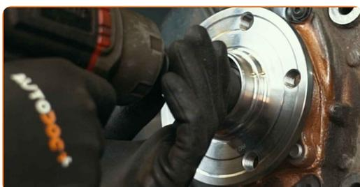
**56** Behandeln Sie die Radnabe an der Kontaktstelle mit der Bremsscheibe. Benutzen Sie ein Kupferschmiermittel.
