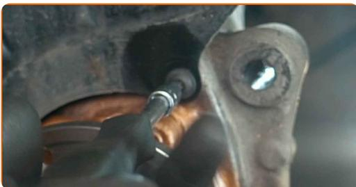
**48** Die Keilwellen des CV-Gelenks der Antriebswelle reinigen. Benutzen Sie eine Drahtbürste. Benutzen Sie WD-40-Spray.
