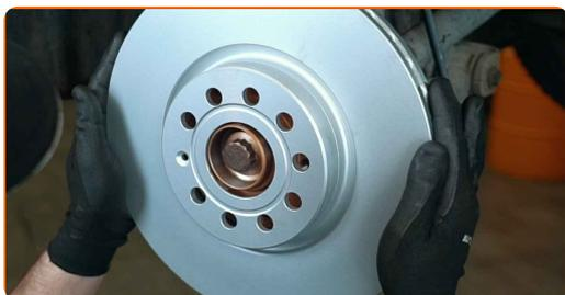
**58** Ziehen Sie die Befestigung der Bremsscheibe fest. Verwenden Sie den Torx T30. Verwenden Sie einen Drehmomentschlüssel. Ziehen Sie ihn mit 4 Nm Drehmoment fest.
