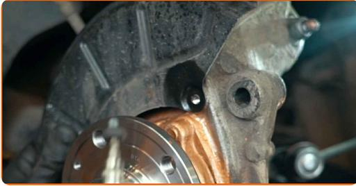
**47** Drehen Sie die Befestigungen des Bremsenabdeckblechs ein. Verwenden Sie den Torx T27. Verwenden Sie einen Ratschenschlüssel.
