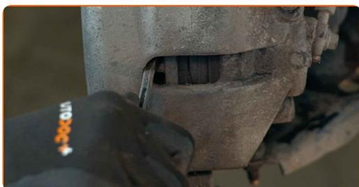
**11** Entfernen Sie die Staubschutzkappen der Bremssattel-Führungsstifte. Benutzen Sie ein Brecheisen.
