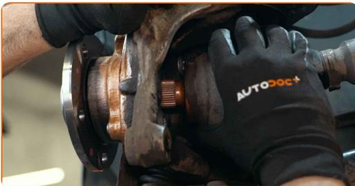
**50** Verbinden Sie das Kugelgelenk mit dem Lenker.
