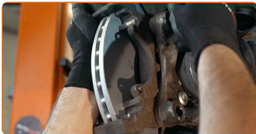
**61** Befestigen Sie die Bremssattelhalterung. Verwenden Sie Stecknuss Nr. 21. Verwenden Sie einen Drehmomentschlüssel. Ziehen Sie ihn mit 175 Nm Drehmoment fest.
