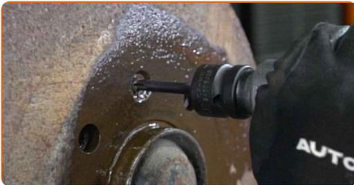
**8** Entfernen Sie die Befestigungsschrauben.
