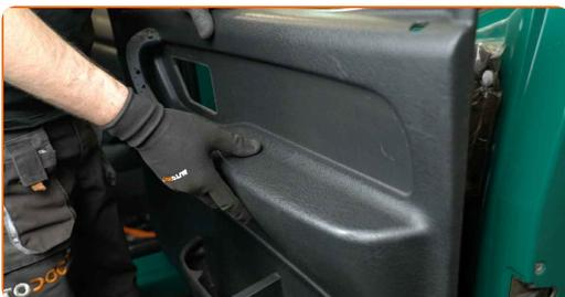
**10** Lösen Sie die Schalldämmung des Türblechs.
