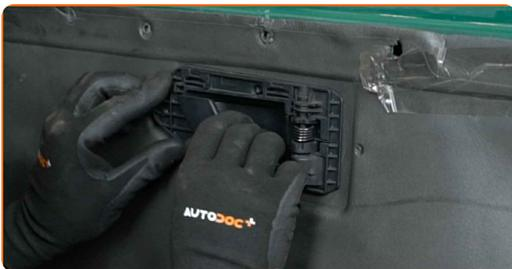
**28** Bauen Sie die Türinnenverkleidung wieder ein. Stellen Sie sicher, dass Sie dabei das Klicken hören, welches entsteht, wenn sich diese in der korrekten Position befindet.
