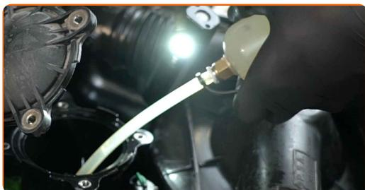
**9** Installieren Sie einen neuen Kraftstofffilter.
