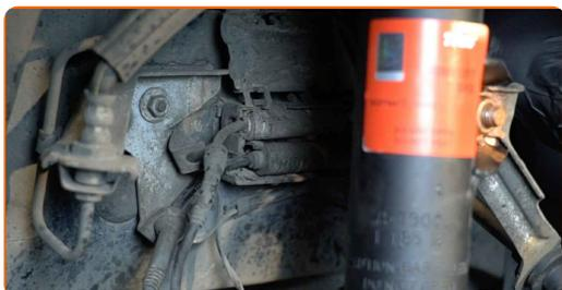
**8** Reinigen Sie den Stecker des Bremsbelagverschleißsensors. Verwenden Sie eine Nylon-Reinigungsbürste.
