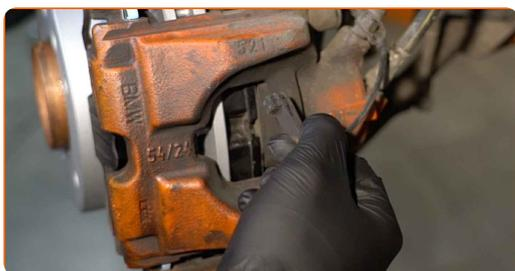
**7** Trennen Sie den Bremsbelag Verschleißsensor.
