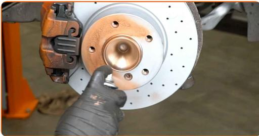
**15** Die Bremsscheibenoberfläche reinigen. Benutzen Sie einen Bremsenreiniger.
