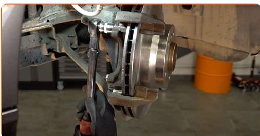
**29** Behandeln Sie den Bremssattel-Kolben. Benutzen Sie einen Bremsenreiniger.
