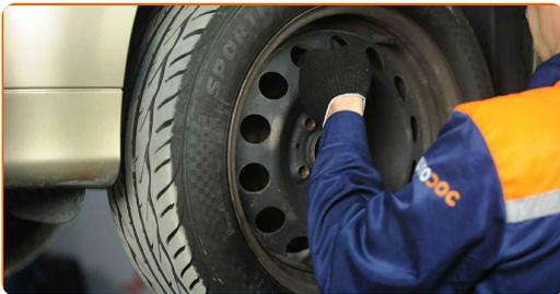
**7** Lösen Sie die Bremssattel-Haltefeder. Verwenden Sie einen flachen Schraubendreher.
