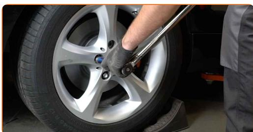
**36** Entfernen Sie den Wagenheber sowie die Unterlegkeile.
