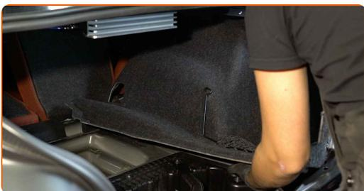
**38** Schrauben Sie das Befestigungselement der Seitenauskleidung des Kofferraums ein. Verwenden Sie den Torx T40. Verwenden Sie einen Ratschenschlüssel.
