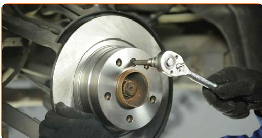
**23** Säubern Sie die Halterung des Bremssattels. Benutzen Sie eine Drahtbürste. Benutzen Sie einen Bremsenreiniger.
