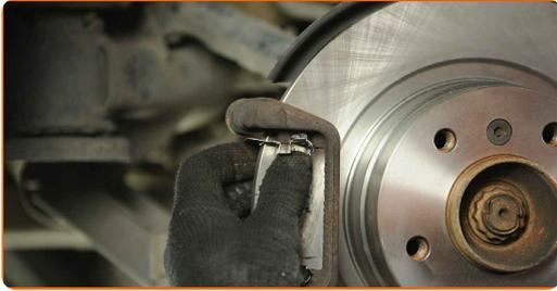
**33** Bringen Sie die Bremsbeläge an. Verwenden Sie einen flachen Schraubendreher.
