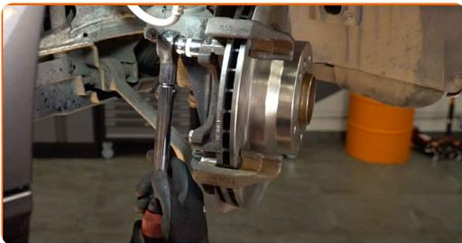
**32** Bringen Sie die Halteclips der Bremsbeläge an.
