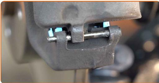
**25** Reinigen Sie die Bremssattel-Führungstifte. Benutzen Sie einen Bremsenreiniger.
