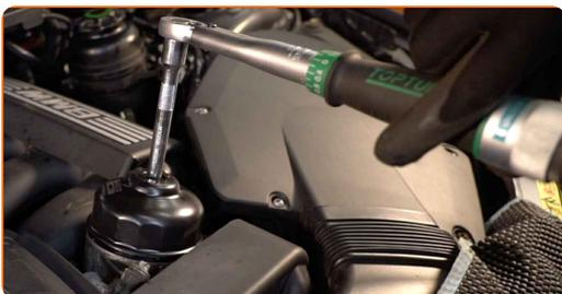
**29** Entfernen Sie die Öleinfüllschraube. Setzen Sie den Trichter ein.
