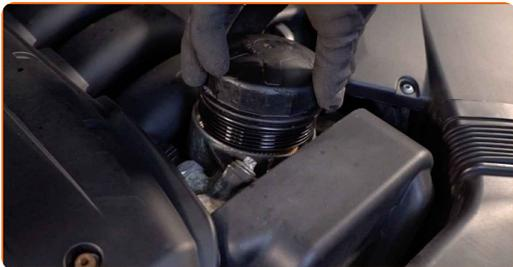
**28** Befestigen Sie die Abdeckung des Ölfiltergehäuses. Verwenden Sie Steckschlüssel 86-16F. Verwenden Sie einen Drehmomentschlüssel. Ziehen Sie ihn mit 25 Nm Drehmoment fest.
