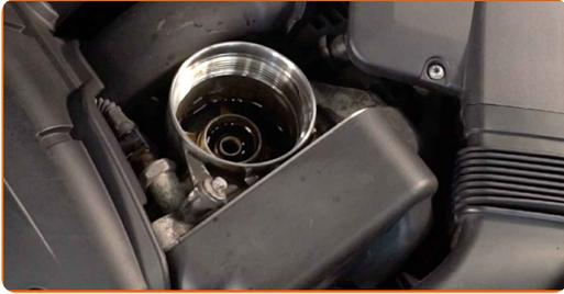
**26** Schmieren Sie die Gummidichtung des neuen Filters mit einer kleinen Menge frischen Öls.
