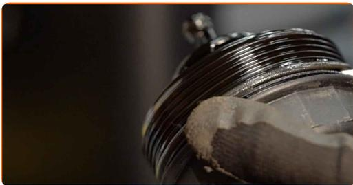
**22** Entfernen Sie die alten O-Ringe aus dem Ölfilterdeckel. Verwenden Sie einen flachen Schraubendreher.
