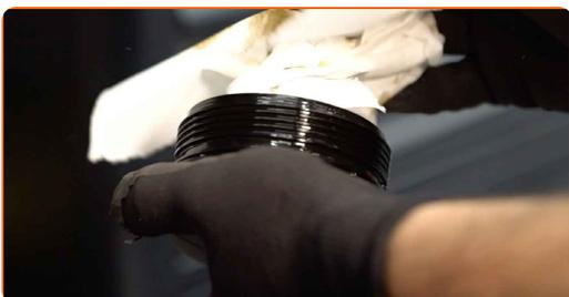
**24** Setzen Sie neue O-Ringe sowie einen neuen Ölfilter in deren Aufnahmen an der Filterabdeckung ein.
