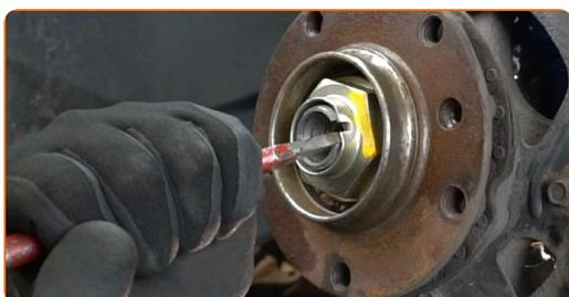
**15** Schrauben Sie die Nabenmutter ab. Verwenden Sie Stecknuss Nr. 46. Verwenden Sie ein Windeisen.
