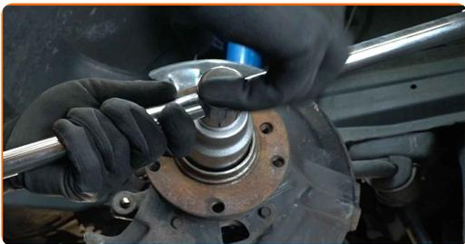
**16** Entfernen Sie die Befestigungsmutter.
