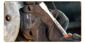
Schrauben Sie die Befestigung des Bremssattels ab. Verwenden Sie Inbusschlüssel Nr. H7. Verwenden Sie einen Ratschenschlüssel.
