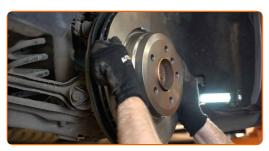
Ziehen Sie die Befestigung der Bremsscheibe fest. Verwenden Sie Inbusschlüssel Nr. H5. Verwenden Sie einen Drehmomentschlüssel. Ziehen Sie ihn mit 16 Nm Drehmoment fest.
