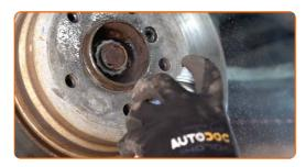
Lösen Sie die Befestigung der Bremsscheibe. Verwenden Sie Inbusschlüssel Nr. H5. Verwenden Sie einen Schlagschrauber.
