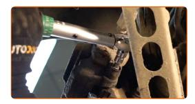
Installieren Sie die Staubschutzkappen der Bremssattel-Führungsstifte.
