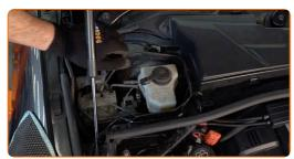
Schrauben Sie die Kappe des Bremsflüssigkeitsausgleichsbehälters ab.
