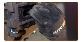
Bauen Sie die Bremssattel-Haltefeder ein. Benutzen Sie ein Brecheisen.
