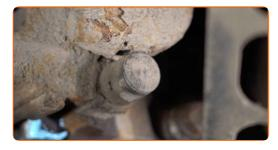
34 Verbinden Sie den Bremsbelag-Verschleiß-Sensor.
