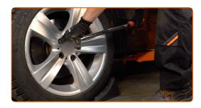
Entfernen Sie den Wagenheber sowie die Unterlegkeile.
