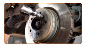
Entfernen Sie die Bremsscheibe.
