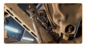
Behandeln Sie den Bremssattel-Kolben. Benutzen Sie einen Bremsenreiniger.
