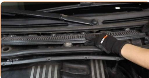
**37** Installieren Sie das Filtergehäuse.
