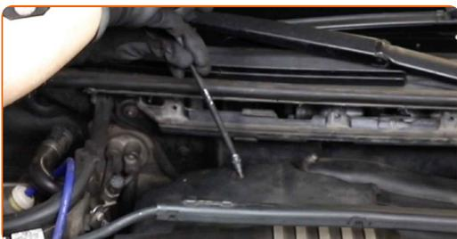
**33** Setze die Komponenten des Lüftungskanals wieder ein.
