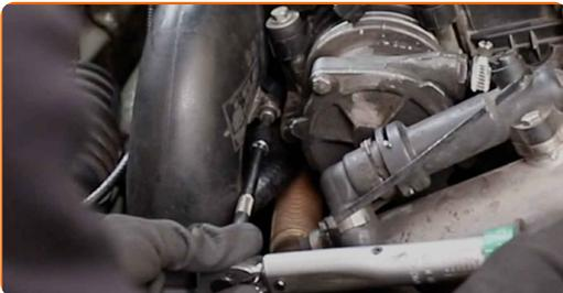
27 Behandeln Sie den Steckverbinder des Luftmassenmessers. Verwenden Sie dielektrisches Fett.
