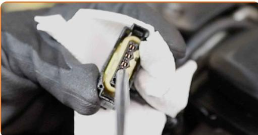
28 Bringen Sie den Steckverbinder des Luftmassenmessers an.
