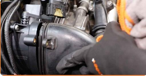
26 Schrauben Sie die Befestigungen fest, die den Luftkanal mit dem Luftmassenmesser verbinden. Verwenden Sie Inbusschlüssel Nr. H5. Verwenden Sie einen Drehmomentschlüssel. Ziehen Sie ihn mit 5 Nm Drehmoment fest.
