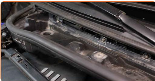
**35** Schrauben Sie die Befestigungen des Innenraumfiltergehäuses ein. Verwenden Sie den Torx T30. Verwenden Sie einen Ratschenschlüssel.
