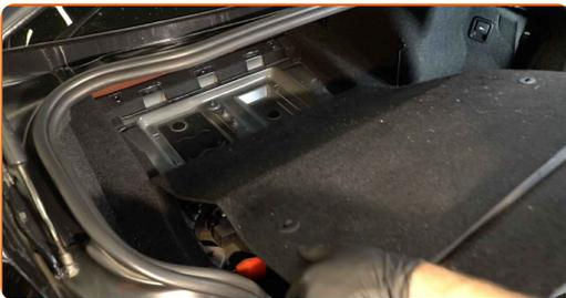
**4** Schrauben Sie das Befestigungselement der zentralen Schutzverkleidung aus Kunststoff heraus. Verwenden Sie einen Kreuzschlitzschraubendreher. Verwenden Sie einen Lösehebel, um die Clips zu entfernen. Verwenden Sie den Torx T40. Verwenden Sie einen Ratschenschlüssel.
