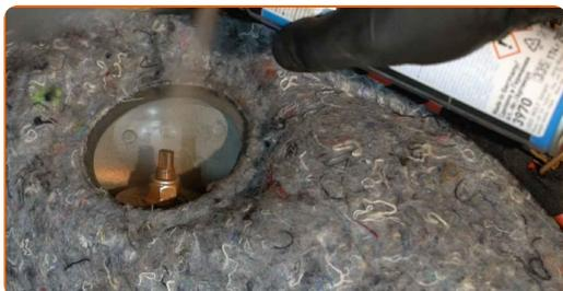
**28** Bringen Sie die Befestigungskappe am oberen Befestigungselement des Stoßdämpfers an.
