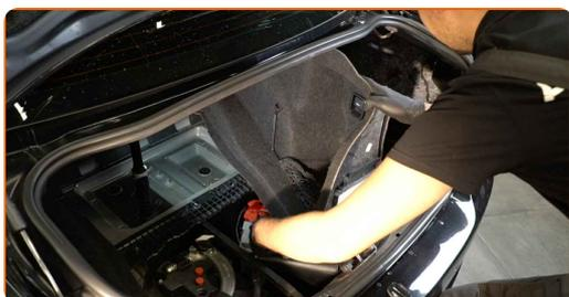
**8** Entfernen Sie die Befestigungskappe vom oberen Befestigungselement des Stoßdämpfers.
