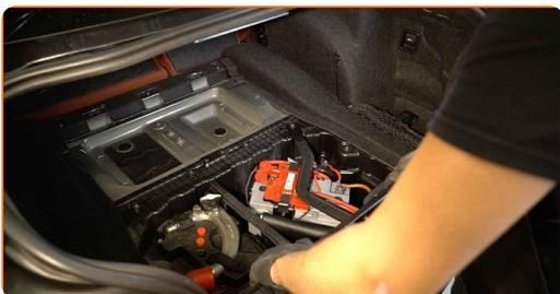
**40** Schrauben Sie das Befestigungselement der zentralen Schutzverkleidung aus Kunststoff ein. Verwenden Sie einen Kreuzschlitzschraubendreher. Verwenden Sie den Torx T40. Verwenden Sie einen Ratschenschlüssel.
