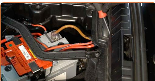
**5** Entfernen Sie die zentrale Schutzverkleidung aus Kunststoff.
