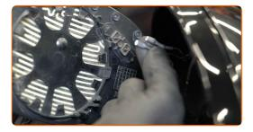
Schließen Sie die Steckverbindungen der Spiegelheizung wieder an.
