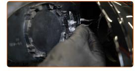
Bauen Sie das neue Spiegelglas ein. Stellen Sie sicher, dass Sie dabei das Klicken hören, welches entsteht, wenn sich diese in der korrekten Position befindet.
