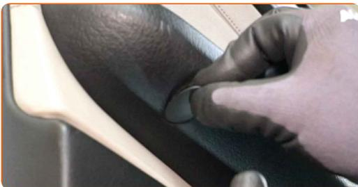
**46** Behandeln Sie die Stecker der Seitenspiegelsteuerung. Verwenden Sie dielektrisches Fett.
