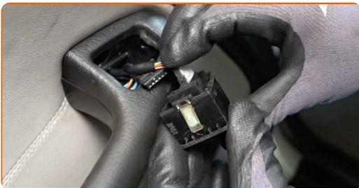
**48** Schließen Sie das Steuergerät des Seitenspiegels an.
