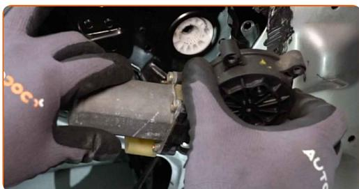
**20** Schrauben Sie die Befestigungen des Fensterglases ab. Verwenden Sie Stecknuss Nr. 8. Verwenden Sie einen Ratschenschlüssel.
