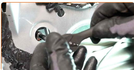
**21** Heben Sie das Glas leicht an und entfernen Sie es.
