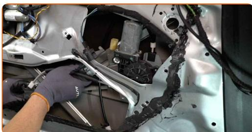
**28** Ziehen Sie die Befestigungselemente der Fensterheberbaugruppe fest. Verwenden Sie Stecknuss Nr. 10. Verwenden Sie einen Drehmomentschlüssel. Ziehen Sie ihn mit 11 Nm Drehmoment fest.
