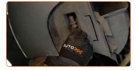
Reinigen Sie alle Verbindungen des Querlenkers. Benutzen Sie eine Drahtbürste. Benutzen Sie WD-40-Spray.
