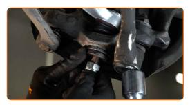
Schrauben Sie die Befestigungen des Kugelgelenks ein. Verwenden Sie Stecknuss Nr. 22. Verwenden Sie einen Ratschenschlüssel.
