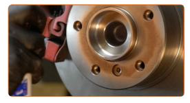
Die Bremsscheibenoberfläche reinigen. Benutzen Sie einen Bremsenreiniger.
