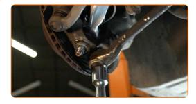
Ziehen Sie die unteren Befestigungen an, die das Federbein mit dem Achsschenkel verbinden. Verwenden Sie Ring-Gabelschlüssel Nr. 18. Verwenden Sie Stecknuss Nr. 16. Verwenden Sie einen Drehmomentschlüssel. Ziehen Sie ihn mit 81 Nm Drehmoment fest.
