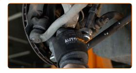
Schrauben Sie das untere Befestigungselement ab, dass das Federbein mit dem Achsschenkel verbindet. Verwenden Sie Ring-Gabelschlüssel Nr. 18. Verwenden Sie Stecknuss Nr. 16. Verwenden Sie einen Ratschenschlüssel.
