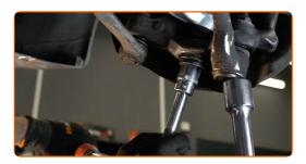
Entfernen Sie den Träger unter dem Arm.
