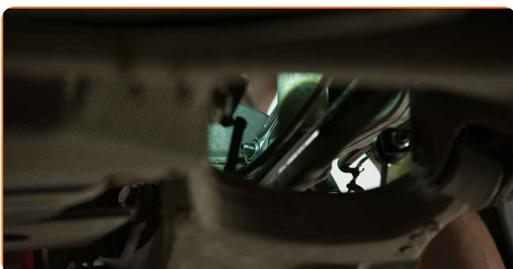
**12** Lösen Sie den Aufhängungsarm vom hinteren Achsschenkel.
