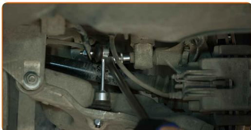
**16** Entfernen Sie die Befestigungsschraube. Verwenden Sie Ring-Gabelschlüssel Nr. 18. Verwenden Sie einen flachen Schraubendreher.
