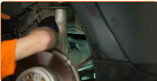
**10** Entfernen Sie die vordere Befestigung des Querlenkers.
