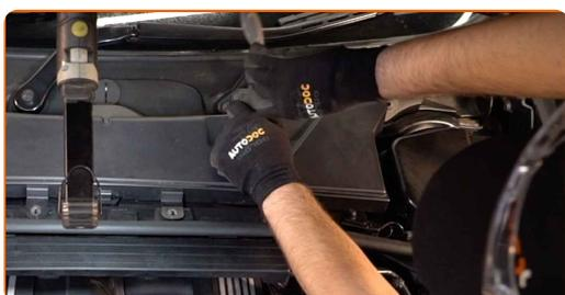
**36** Entfernen Sie die Kotflügel-Abdeckung.
