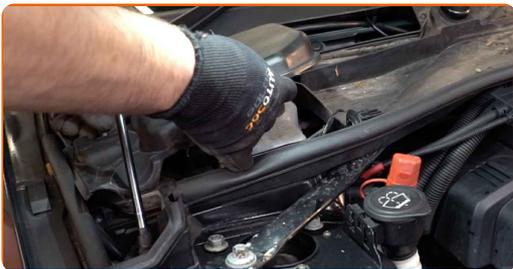
**6** Lösen Sie die Steckverbinder der Climate-Control-Sensoren.
