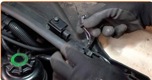
**7** Entfernen Sie die Climate-Control-Sensoren.
