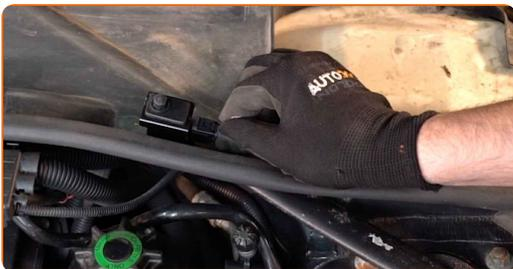
**32** Bringen Sie die Halterungen des oberen Bereichs des Mikrofilter-Gehäuses an.
