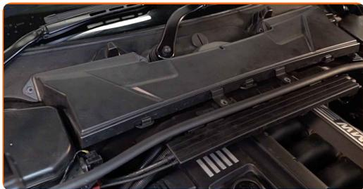
**35** Schrauben Sie die Verbindungselemente der Innenfilter-Gehäuseabdeckung ein. Verwenden Sie Stecknuss Nr. 8. Verwenden Sie einen Ratschenschlüssel.
