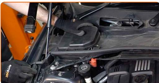
**34** Installieren Sie den Gehäusedeckel des Innenraumfilters.
