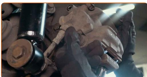
**23** Verbinden Sie den Bremsbelag-Verschleiß-Sensor. Verwenden Sie eine Rundzange.
