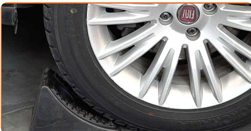
**3** Lösen Sie die Radhalterungsschrauben. Verwenden Sie eine Schlagnuss für Felgen # 17.
