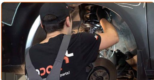
**38** Schrauben Sie die obere Befestigung des Federbeinbefestigung an. Schrauben Sie diese nicht fest.
