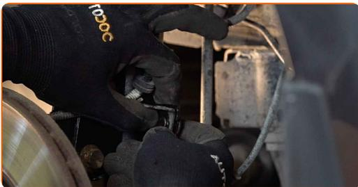
**52** Ziehen Sie die Befestigungsklammer des Bremsschlauchs am Federbein an. Verwenden Sie Stecknuss Nr. 10. Verwenden Sie einen Ratschenschlüssel.
