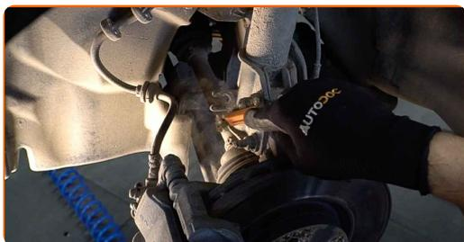
**13** Schrauben Sie die Mutter ab und entfernen Sie die Stabilisatorstange aus dem Federbein. Verwenden Sie Ring-Gabelschlüssel Nr. 17. Verwenden Sie einen Ratschenschlüssel.
