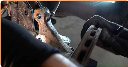
**18** Lösen Sie die obere Befestigung der Federbeinbefestigung. Verwenden Sie Stecknuss Nr. 19. Verwenden Sie einen Ratschenschlüssel.
