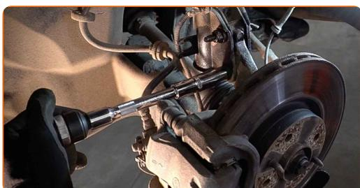
**16** Entfernen Sie die Befestigungsschrauben.
