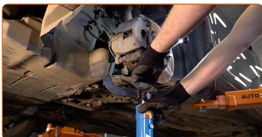
**15** Schrauben Sie das untere Befestigungselement ab, dass das Federbein mit dem Achsschenkel verbindet. Verwenden Sie Ring-Gabelschlüssel Nr. 15. Verwenden Sie Stecknuss Nr. 17. Verwenden Sie ein Windeisen.
