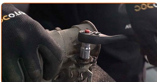
**50** Entfernen Sie die Halterung der Stoßdämpferstrebe.
