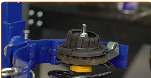
**36** Entfernen Sie das zusammengebaute Federbein.
