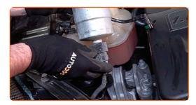
Bringen Sie den Anschluss des Kraftstoffdrucksensors an.
