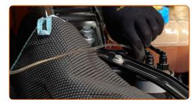
Schrauben Sie die Kraftstofffilter-Entlüftungsschraube ein. Verwenden Sie Stecknuss Nr. 12. Verwenden Sie einen Ratschenschlüssel.
