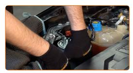
Ziehen Sie die Befestigungsmittel des Treibstofffilters fest. Verwenden Sie Stecknuss Nr. 10. Verwenden Sie einen Ratschenschlüssel.
