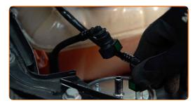
Verbinden Sie das Entlüftungskit mit der Kraftstofffilter-Entlüftungsschraube.
