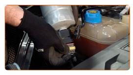
Installieren Sie einen neuen Kraftstofffilter.
