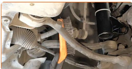
**7** Schrauben Sie das Befestigungselement heraus, das die Druckstange mit dem Federbein verbindet. Verwenden Sie Stecknuss Nr. 16. Verwenden Sie einen Ratschenschlüssel.
