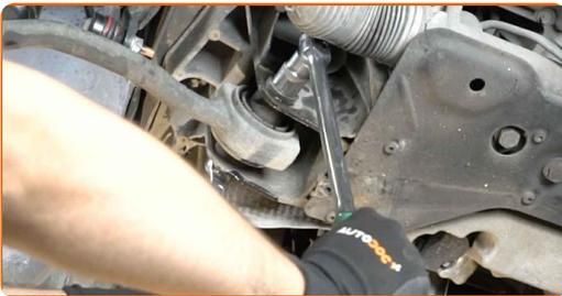
**10** Reinigen Sie alle Verbindungen des Querlenkers. Benutzen Sie eine Drahtbürste. Benutzen Sie WD-40-Spray.
