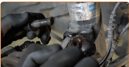
**24** Ziehen Sie den Achsschenkel vom Dämpferbein ab. Benutzen Sie ein Brecheisen.
