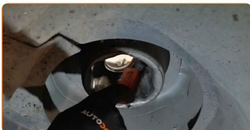
**47** Installieren Sie das Federbein am Radlauf.
