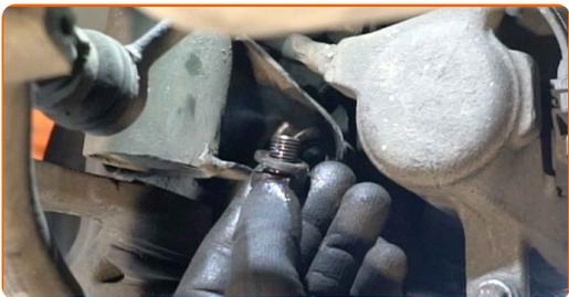
**21** Ziehen Sie den Achsschenkel vom Dämpferbein ab. Benutzen Sie ein Brecheisen.
