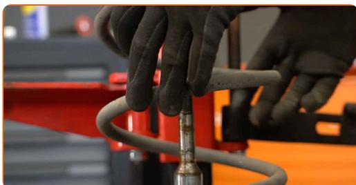
**34** Die Staubkappe des Stoßdämpfers und den Anschlagpuffer entfernen.
