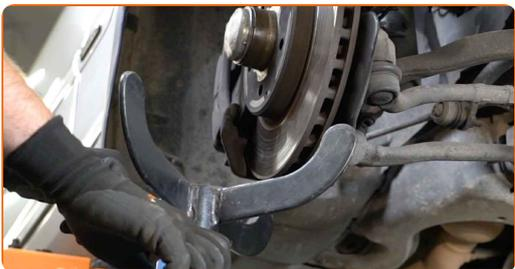
**23** Entfernen Sie die Befestigungsschraube.
