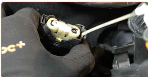
**17** Bringen Sie den Steckverbinder des Luftmassenmessers an.
