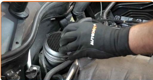
**12** Lösen Sie die Halteklammern des Luftmassenmessers. Benutzen Sie ein Brecheisen.
