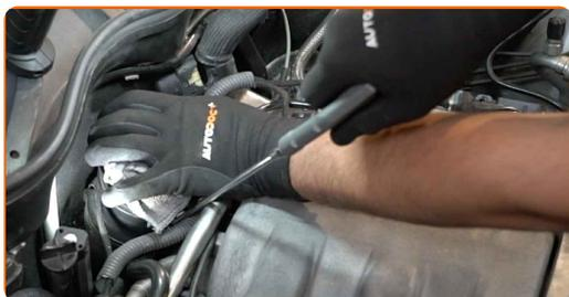
**11** Entfernen Sie das Mikrofasertuch von der Drosselklappe.
