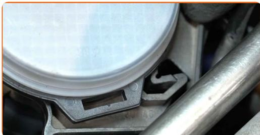
**16** Behandeln Sie den Steckverbinder des Luftmassenmessers. Verwenden Sie dielektrisches Fett.
