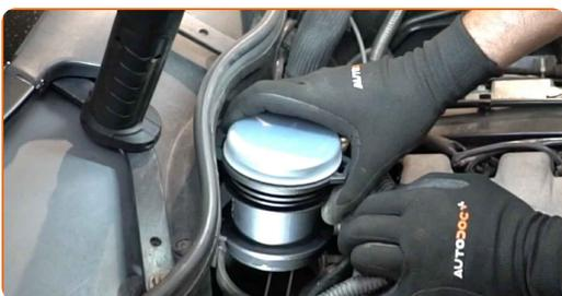
**15** Schließen Sie die Halteklammern des Luftmassenmessers.
