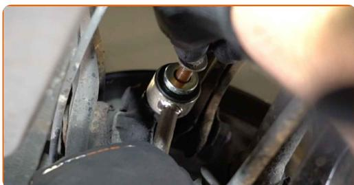
**12** Stützen Sie den hinteren Arm. Benutzen Sie einen hydraulischen Getriebeheber.
