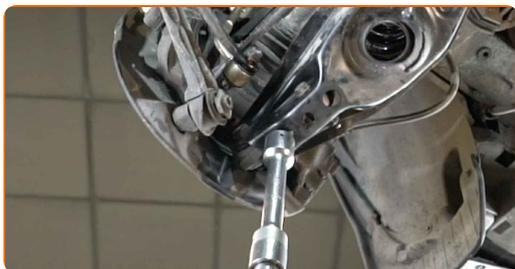
**13** Ziehen Sie die Befestigungen an, die die Koppelstange mit dem Achsschenkel verbinden. Verwenden Sie Stecknuss Nr. E14. Verwenden Sie einen Drehmomentschlüssel. Ziehen Sie ihn mit 40 Nm Drehmoment fest.
