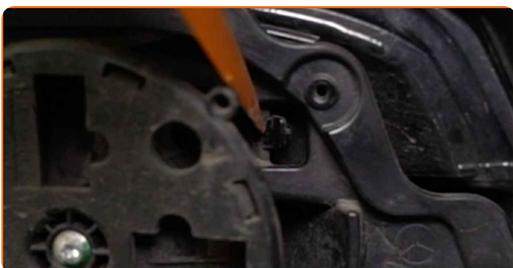
**12** Entfernen Sie das Außenspiegelgehäuse.
