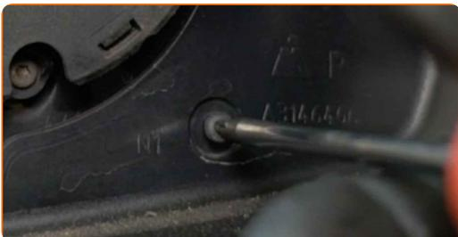
**9** Lösen Sie die Laschen des Rahmens des Spiegelgehäuses. Verwenden Sie einen flachen Schraubendreher.
