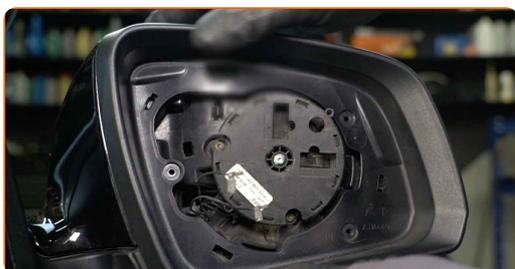
**24** Rasten Sie die Laschen des Rahmens des Spiegelgehäuses wieder ein. Stellen Sie sicher, dass Sie dabei das Klicken hören, welches entsteht, wenn sich diese in der korrekten Position befindet.
