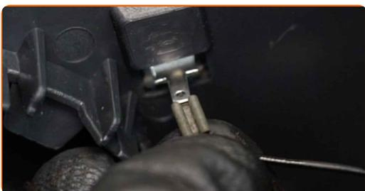
**28** Setzen Sie das Spiegelglas ein. Stellen Sie sicher, dass Sie dabei das Klicken hören, welches entsteht, wenn sich diese in der korrekten Position befindet.
