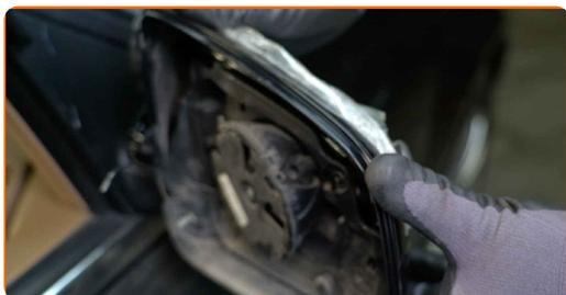
**22** Rasten Sie die Laschen der Zusatzblinker wieder am Spiegelgehäuse ein. Stellen Sie sicher, dass Sie dabei das Klicken hören, welches entsteht, wenn sich diese in der korrekten Position befindet.
