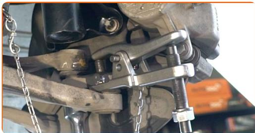
**11** Entfernen Sie den Träger unter dem Achsschenkel.
