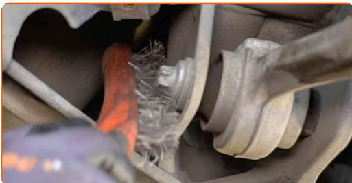
**7** Schrauben Sie die Befestigung ab, die den Querlenker mit dem Hilfsrahmen verbindet. Verwenden Sie Ring-Gabelschlüssel Nr. 21. Verwenden Sie den Torx E20. Verwenden Sie einen Ratschenschlüssel.
