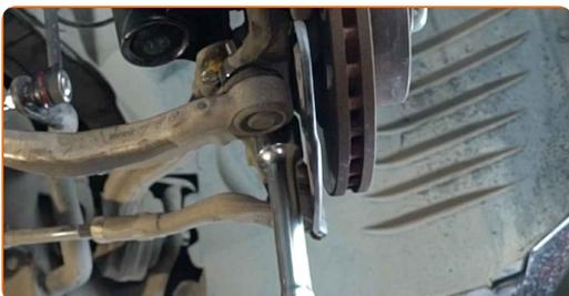
**10** Trennen Sie das Kugelgelenk vom Achsschenkel. Verwenden Sie einen Kugelgelenkabzieher.
