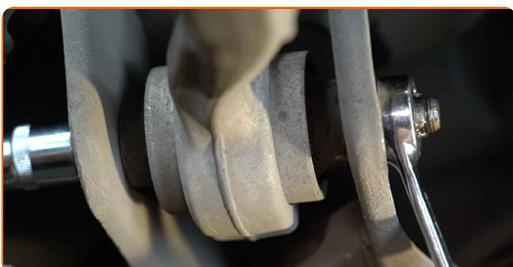
**8** Schrauben Sie die Kugelgelenkbefestigung vom Achsschenkel ab. Verwenden Sie Ring-Gabelschlüssel Nr. 21.
