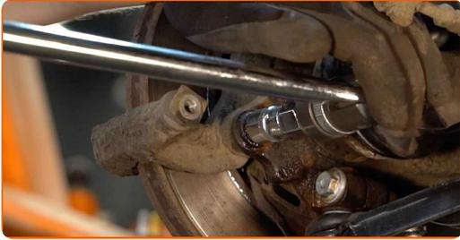
**14** Entfernen Sie die Sattelhalterung.
