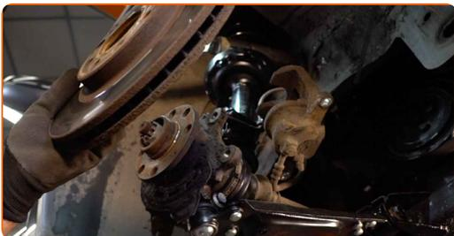
**Austausch: Bremsscheiben – Opel Corsa C. AUTODOC-Experten empfehlen:**
