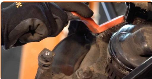
**13** Lösen Sie die Befestigung der Sattelhalterung. Verwenden Sie Stecknuss Nr. E18. Verwenden Sie ein Windeisen.
