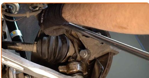
**15** Entfernen Sie die Sattelhalterung.
