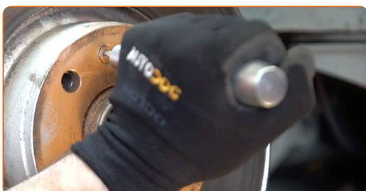
**17** Entfernen Sie die Bremsscheibe.
