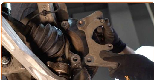
**16** Lösen Sie die Befestigung der Bremsscheibe. Verwenden Sie den Torx T30. Verwenden Sie einen Ratschenschlüssel.
