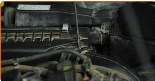
**4** Trennen Sie das Luftkanal-Gehäuse vom Luftfilter-Gehäuse.
