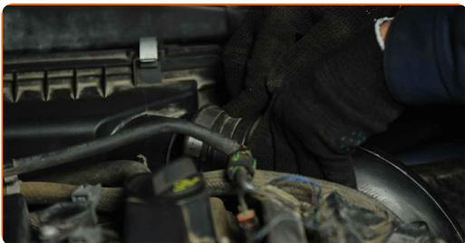
**15** Ziehen Sie die Klemme am Luftansaugschlauch fest. Verwenden Sie einen flachen Schraubendreher.
