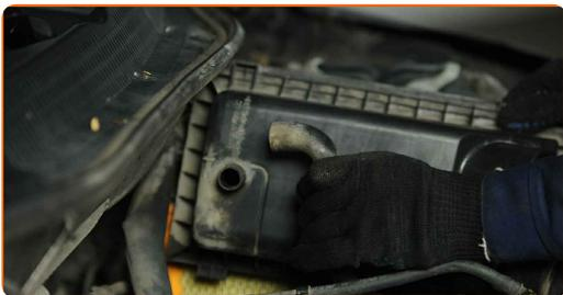
**7** Entfernen Sie die Abdeckung des Luftfilters.
