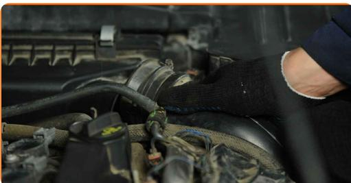
**5** Lösen Sie die Befestigungsclips der Luftfilterabdeckung.
