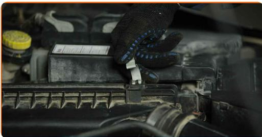
**6** Entfernen Sie den Kurbelgehäuse-Entlüftungsschlauch.
