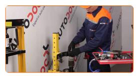
Installieren Sie die Feder am Stoßdämpfer.
