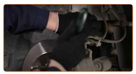
Schrauben Sie die Befestigungen ab, die das Federbein mit dem Achsschenkel verbinden. Verwenden Sie Ring-Gabelschlüssel Nr. 21. Verwenden Sie Stecknuss Nr. 21. Verwenden Sie einen Ratschenschlüssel.
