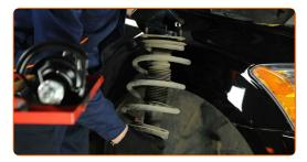
Stellen Sie das Dämpferbein auf das Federspannwerkzeug.
