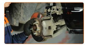
Ziehen Sie die unteren Befestigungen an, die das Federbein mit dem Achsschenkel verbinden. Verwenden Sie Ring-Gabelschlüssel Nr. 21. Verwenden Sie Stecknuss Nr. 21. Verwenden Sie einen Drehmomentschlüssel. Ziehen Sie ihn mit 84 Nm Drehmoment fest.
