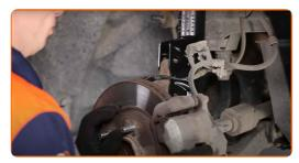
Bringen Sie die Befestigungsschrauben an. Verwenden Sie einen Splintentreiber. Benutzen Sie einen Hammer.
