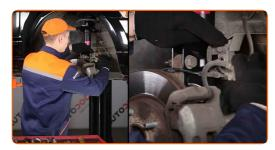
Ziehen Sie die Befestigung an, die die Halterung des Bremsschlauchs mit dem Federbein verbindet. Verwenden Sie Stecknuss Nr. 13. Verwenden Sie einen Ratschenschlüssel.
