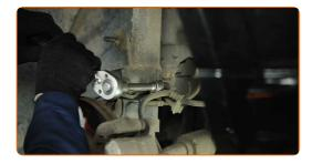
Entfernen Sie die Halterung des Bremsschlauchs.
