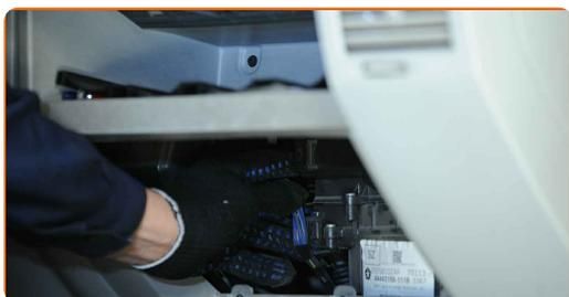
**5** Entfernen Sie die Abdeckung des Innenraumfilters.
