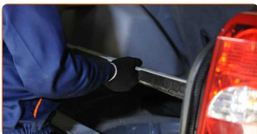
**21** Entfernen Sie die Seitenabdeckung aus Kunststoff.
