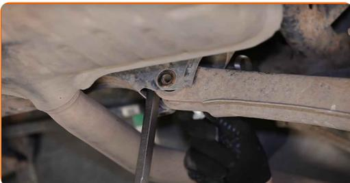
**17** Lösen Sie den Querlenker. Benutzen Sie ein Brecheisen.
