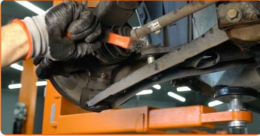
**32** Schrauben Sie das Befestigungselement heraus, das den Stabilisator mit dem Querlenker verbindet. Verwenden Sie Ring-Gabelschlüssel Nr. 12. Verwenden Sie Stecknuss Nr. 12. Verwenden Sie einen Ratschenschlüssel.
