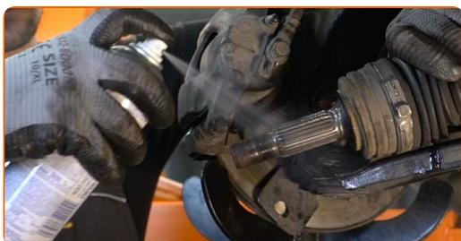
**63** Entfernen Sie den Träger unter dem Achsschenkel.
