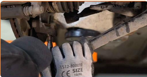
**34** Entfernen Sie die Antriebswelle. Verwenden Sie einen Splintentreiber. Benutzen Sie einen Hammer.
