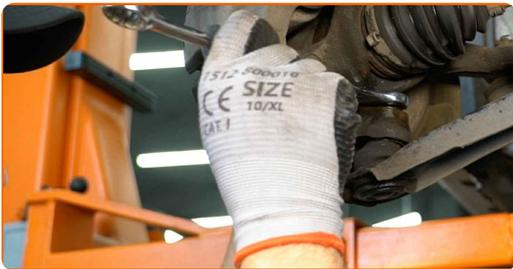
**30** Ziehen Sie den unteren Arm vom Achsschenkel ab. Verwenden Sie einen Kugelgelenkabzieher.
