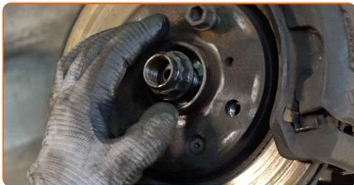
**76** Die Antriebswellenmutter festziehen. Verwenden Sie Stecknuss Nr. 30. Verwenden Sie einen Drehmomentschlüssel. Ziehen Sie ihn mit 216 Nm Drehmoment fest.
