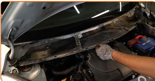
**87** Schrauben Sie die Befestigungen der Scheibenwischerverkleidung ein. Verwenden Sie Stecknuss Nr. 10. Verwenden Sie einen Ratschenschlüssel.
