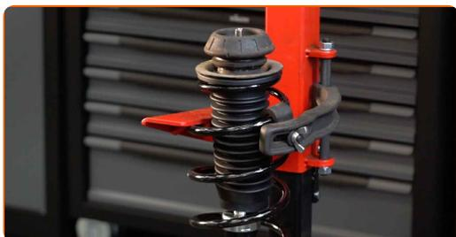
**56** Entfernen Sie das zusammengebaute Federbein.
