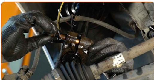
**62** Die Keilwellen des CV-Gelenks der Antriebswelle reinigen. Benutzen Sie eine Drahtbürste. Benutzen Sie WD-40-Spray.
