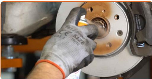
**80** Die Bremsscheibenoberfläche reinigen. Benutzen Sie einen Bremsenreiniger.
