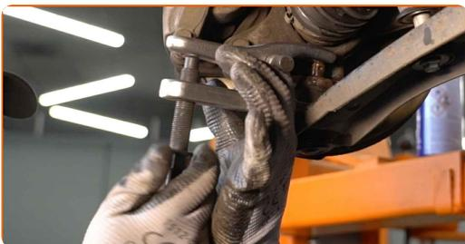
**31** Reinigen Sie die Befestigungen der Koppelstange. Benutzen Sie eine Drahtbürste. Benutzen Sie WD-40-Spray.
