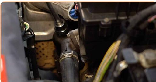
**22** Entfernen Sie die Öleinfüllschraube. Setzen Sie den Trichter ein.
