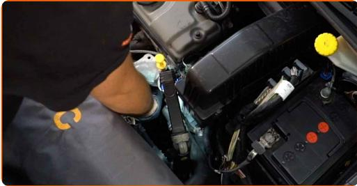
**21** Befestigen Sie die Abdeckung des Ölfiltergehäuses. Verwenden Sie Stecknuss Nr. 27. Verwenden Sie einen Drehmomentschlüssel. Ziehen Sie ihn mit 25 Nm Drehmoment fest.
