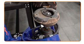
Ziehen Sie die Federbeinkolbenstangenmutter an. Verwenden Sie Ring-Gabelschlüssel Nr. 19. Verwenden Sie Inbusschlüssel Nr. H7. Verwenden Sie einen Drehmomentschlüssel. Ziehen Sie ihn mit 60 Nm Drehmoment fest.
