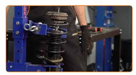
Entfernen Sie das zusammengebaute Federbein.
