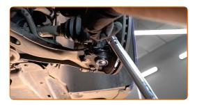
Ziehen Sie das Befestigungselement an, das die Druckstange mit dem Federbein verbindet. Verwenden Sie Stecknuss Nr. 16. Verwenden Sie einen Drehmomentschlüssel. Ziehen Sie ihn mit 43 Nm Drehmoment fest.
