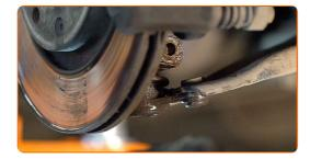
Lösen Sie das Befestigungselement, welches die Antriebswelle mit der Radnabe verbindet. Verwenden Sie Stecknuss Nr. 32. Verwenden Sie ein Windeisen.
