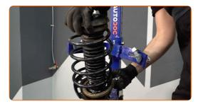
Installieren Sie das Federbein am Radlauf.
