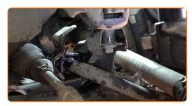
Schrauben Sie die Befestigungen der Stabilisatorbuchsenhalter ein. Verwenden Sie Stecknuss Nr. 18. Verwenden Sie einen Ratschenschlüssel.
