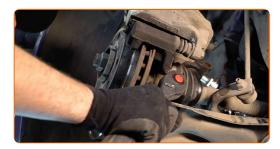
Entfernen Sie die Befestigungsschraube.
