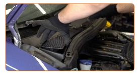
Entfernen Sie die Kappe des Federbeinstützlagers.
