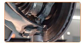
Schrauben Sie das Befestigungselement ein, das das Federbein mit dem Achsschenkel verbindet. Verwenden Sie Stecknuss Nr. 18.
