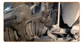
Schrauben Sie die Befestigungen der Stabilisatorbuchsenhalter heraus. Verwenden Sie Stecknuss Nr. 18. Verwenden Sie einen Ratschenschlüssel.
