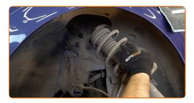
34 Stellen Sie das Dämpferbein auf das Federspannwerkzeug.
