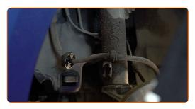
Reinigen Sie die Federbein-Befestigungselemente. Benutzen Sie eine Drahtbürste. Benutzen Sie WD-40-Spray.
