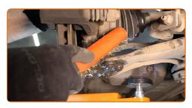
Schrauben Sie die Kugelgelenkbefestigung vom Achsschenkel ab. Verwenden Sie Stecknuss Nr. E8. Verwenden Sie Stecknuss Nr. 18. Verwenden Sie einen Ratschenschlüssel.
