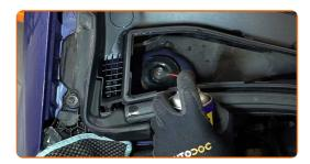
Lösen Sie die obere Befestigung des Domlagers. Verwenden Sie Stecknuss Nr. 21. Verwenden Sie Inbusschlüssel Nr. H7. Verwenden Sie einen Ratschenschlüssel.
