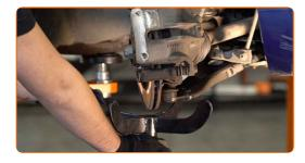
Nehmen Sie die Befestigungselemente heraus, die das Federbein mit dem Achsschenkel verbinden.
