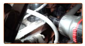
Schrauben Sie das Befestigungselement ein, das das Kugelgelenk mit dem Achsschenkel verbindet. Verwenden Sie Stecknuss Nr. 16. Verwenden Sie Stecknuss Nr. 18. Verwenden Sie einen Ratschenschlüssel.
