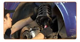
Schrauben Sie die obere Befestigung des Domlagers an. Schrauben Sie diese nicht fest.
