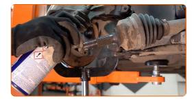
Die Antriebswelle in die Radnabe installieren.
