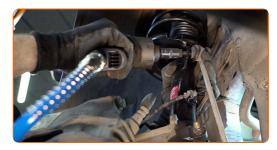
Ziehen Sie die unteren Befestigungen an, die das Federbein mit dem Achsschenkel verbinden. Verwenden Sie Stecknuss Nr. 18. Verwenden Sie einen Drehmomentschlüssel. Ziehen Sie ihn mit 55 Nm Drehmoment fest.
